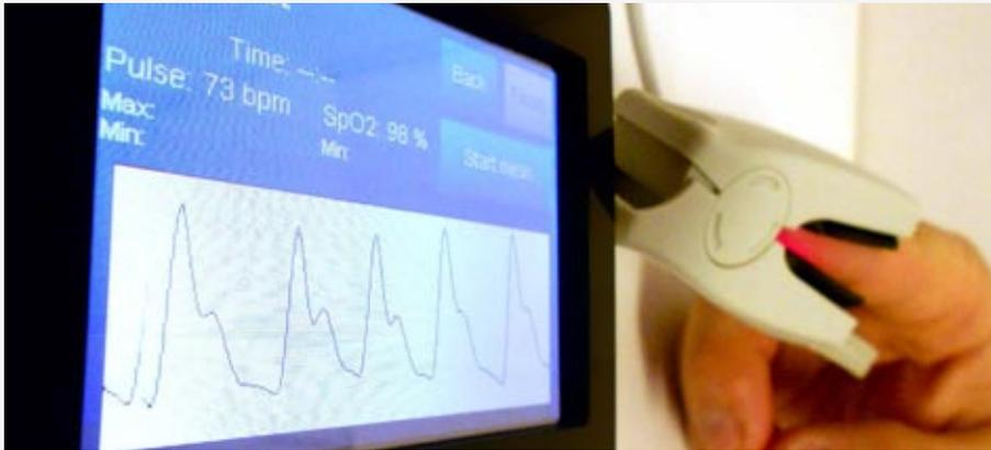
El oxímetro USB (OxiThor) está disponible como opción a OTTHON. El dispositivo puede correr tests cortos (GP Edition) o tests durante la noche (Extended Edition) y almacenar los datos en su memoria. Pulso, saturación de hemoglobina oxigenada se muestran en tiempo real en la pantalla LCD.
